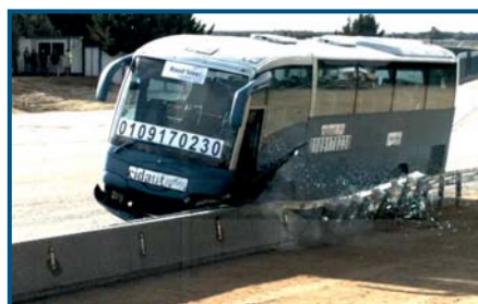
Ensayo TB 51 Autocar de 13.000 Kg., a 70 Km/h y 20°
